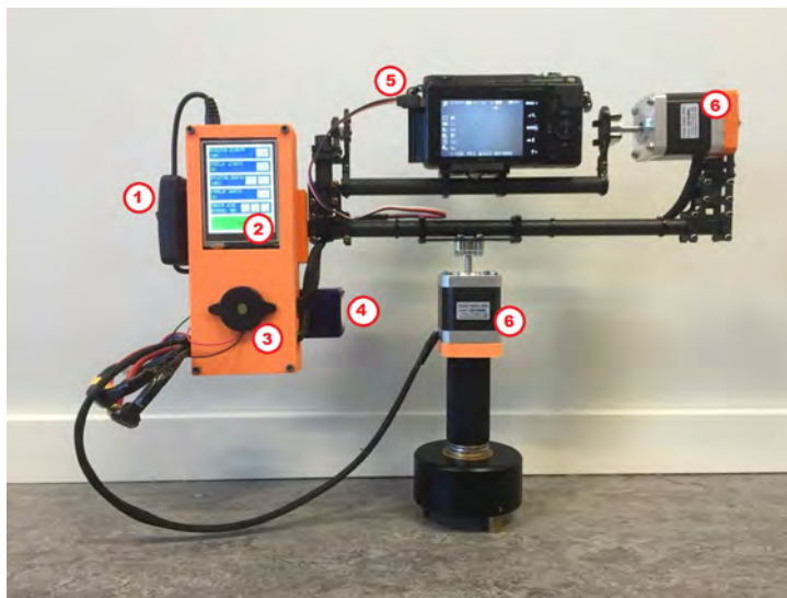
Figur 9: De synliga komponenterna i plattformen är 1) switchen där Arduinot stängs av/på, 2) pekskärmen, 3) buzzern, 4) batterierna fästa på baksidan, 5) triggerkabeln samt 6) stegmotorerna. Den orange lådan som pekskärmen är integrerad i innehåller även Arduinot samt alla elektriska komponenter.
